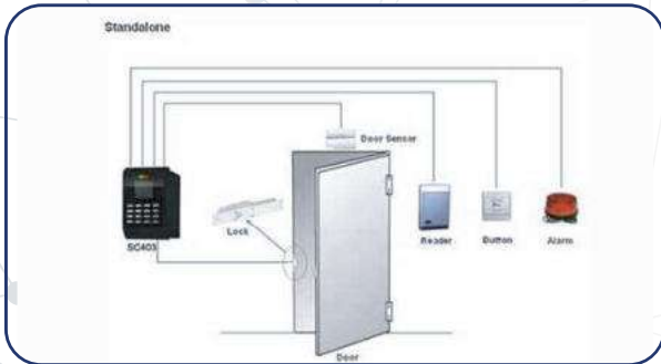
Hệ thống Access-control
